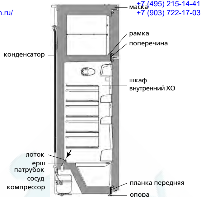
Рисунок 4 — Схема слива талой воды из ХО
